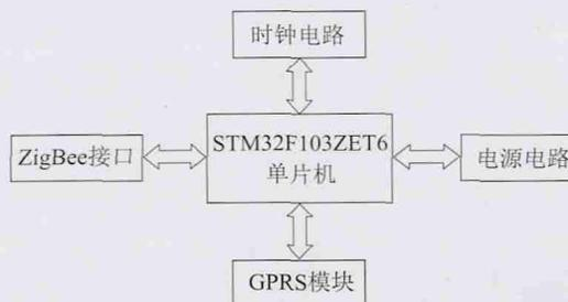
图 2 嵌入式平台硬件设计原理图
